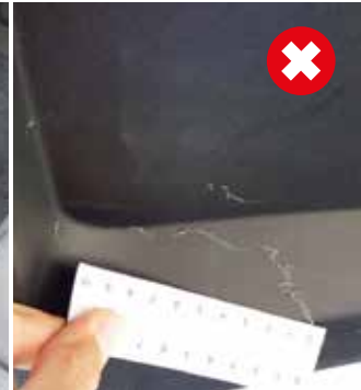
Rayure sensible à l'angle ou arrachement de matière. Garniture cassée, percée, réparation de mauvaise qualité.
